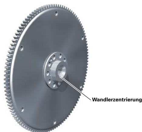
Mitnehmerscheibe (mit der Kurbelwelle verschraubt)
